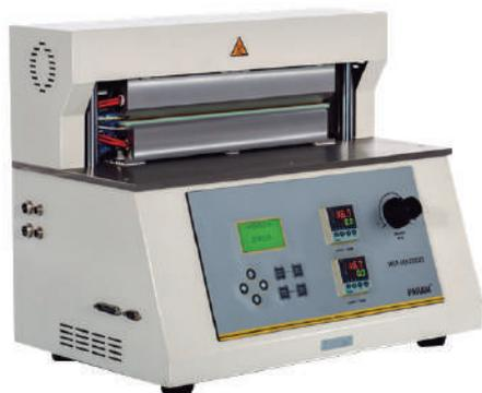
La termoselladora de laboratorio HST-H3 se basa en el método de sellado térmico y es aplicable profesionalmente para la determinación de la temperatura del sellado térmico, el tiempo de permanencia y la presión de varias películas compuestas para guiar la producción industrial. La termoselladora de laboratorio HST-H3 utiliza un diseño de estructura mecánica de precisión.
