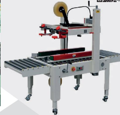
La selladora de cajas posee el sistema de cinta de transmisión en la parte superior e inferior para asegurar el transporte de cartones pesados. El movimiento de máquina puede ser intercambiado de la parte superior a la inferior. La tensión de cinta y cinta adhesiva es fácil de ajustar y es aplicable a cajas duras y blandas.
