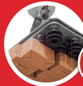
Puede levantar fácilmente cargas de diferentes tamaños y condiciones de superficie. La característica especial de esta innovación es que posee 40 boquillas de aspiración y fuelles incorporados garantizan una adaptación óptima a la superficie.
