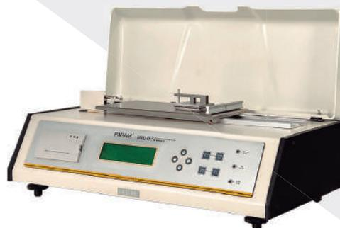
El Equipo medidor de coeficiente de fricción MXD-02 está diseñado para pruebas de coeficiente de fricción estático y cinético de películas de plástico, láminas, caucho, papel, bolsas tejidas de PP, estilo de tela, tiras, ect. Con la prueba de suavidad del material, los usuarios pueden controlar y ajustar los índices técnicos de calidad del material para satisfacer las demandas de la aplicación.
