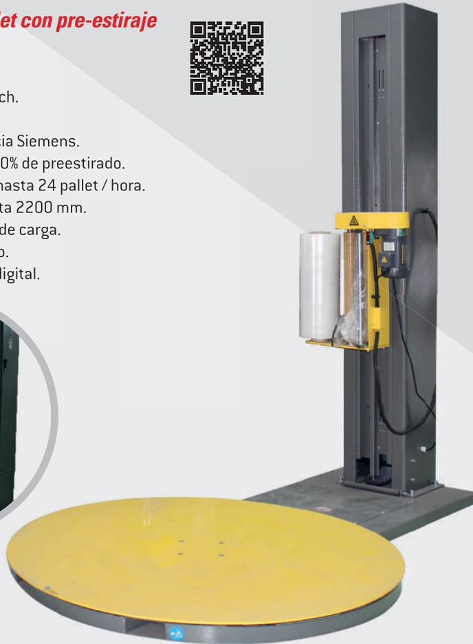
Envolvedora de Palet con control programable y control de inversor de frecuencia, el funcionamiento es fiable y de fácil operación. Se puede medir automáticamente la altura de las mercancías. Giro y reposición automática para asegurar con exactitud la colocación de entrar y salida de la bandeja. Cambio de rollo fácil, que puede utilizar la película fina LLDPE de diámetro externo de 280 mm, anchura de boca 500 mm, núcleo de papel de 76 mm.
