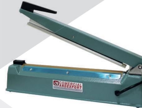
Selladora de sobremesa manual modelo SSM-300.FE, modelo económico y eficiente. Especial para plásticos de Polietileno, Polipropileno. Apta para ser usada en todo tipo de industrias. Este equipo posee control de tiempo de sellado con un sello nicrón de 2mm.
