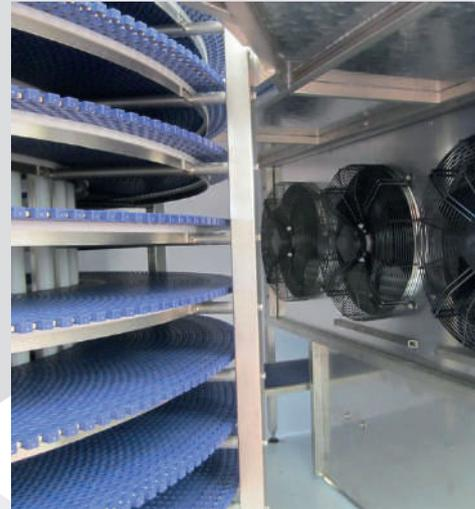
Los túneles de frío con cintas transportadoras continuas SARP son soluciones inteligentes para el tratamiento térmico de productos envasados o a granel, para el secado, esterilización, pasteurización, enfriamiento, congelación o fermentación de diferentes tipos de productos (Pouch con y sin válvula, masas, helados, etc).
