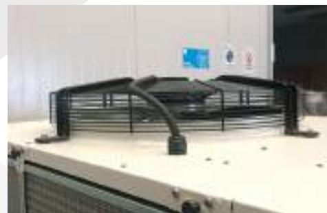
Equipado con un electroventilador con motor de rotor externo de 6 polos enchavetado directamente al ventilador axial, con protección térmica interna en los devanados, completo con rejilla de protección de seguridad y estructura de soporte dedicada. El ventilador está alojado en una boquilla especial con un perfil para optimizar el rendimiento eólico.
