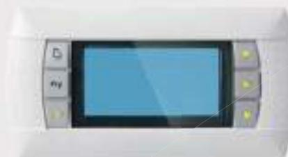
El control electrónico permite una gestión completa de las unidades y es de fácil acceso a través de una puerta de policarbonato, con grado de protección IP65. Al mando se conecta una sonda que detecta la temperatura ambiente. Esta lectura le permite cambiar automáticamente el punto de ajuste para adaptarlo a las condiciones de carga externa o mantener la unidad en funcionamiento incluso en las condiciones invernales más duras.
