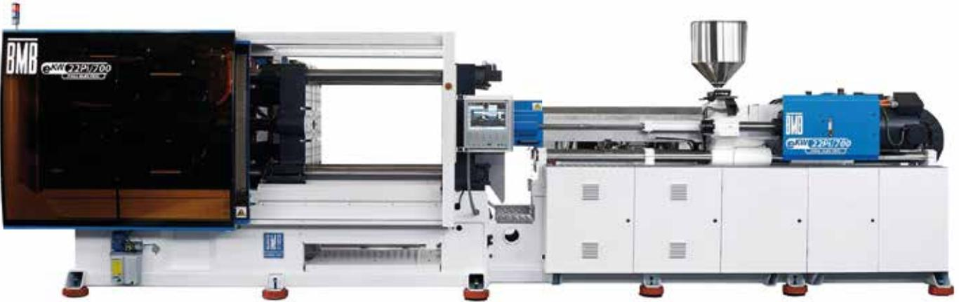
Un nuevo concepto de máquina que se enfoca en la eficiencia y la reducción de los costos de producción, ofrece muchas ventajas: ahorro de energía, menor consumo de agua, disminución significativa de los niveles de ruido, costos mínimos de lubricante debido al uso de tornillos de rodillo de recirculación que trabajan en baños de aceite sellados enfriados por agua. Estas características aseguran una alta confiabilidad, repetibilidad y precisión.
